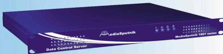
Сервер контроля каналов вещания предназначен для мониторинга и управления мультисервисной платформой MediaSputnik 1000 series. Сервер осуществляет контроль параметров функционирования отдельных компонентов платформы по форме 1xN, производит переключение в автоматическом или полуавтоматическом режиме на резервный комплект и уведомляет оператора о всех изменениях в состоянии системы или отдельных ее сегментов.
